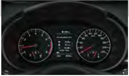
4,2" Supervision cluster Het 4,2" TFT-LCD-display toont alle belangrijke meldingen, bijvoorbeeld bij een lekke band.
