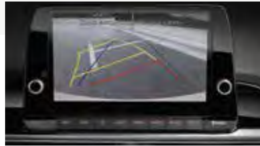
Achteruitrijcamera met begeleiding Met de achteruitrijcamera ingeschakeld toont het 8" 'zwevende' display in de middenconsole live videobeeld van de achteruitrijcamera, inclusief actieve gidslijnen.
