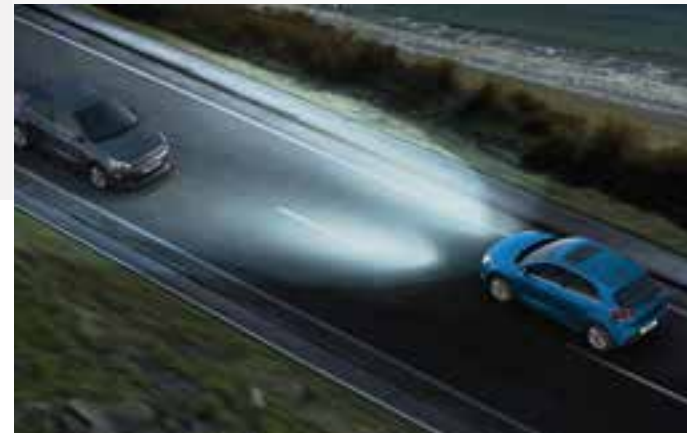
Grootlichtassistentie Camera's in de voorruit van de nieuwe Kia Rio herkennen bij rijden in het donker eventuele tegenliggers. Rijd je met grootlicht aan en nadert er ander verkeer, dan dimt dit systeem je grootlicht totdat de tegenligger voorbij is, om verblinding te voorkomen.
