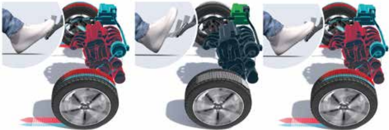
Vereenvoudigde weergave van de Mild Hybrid coasting-functie
