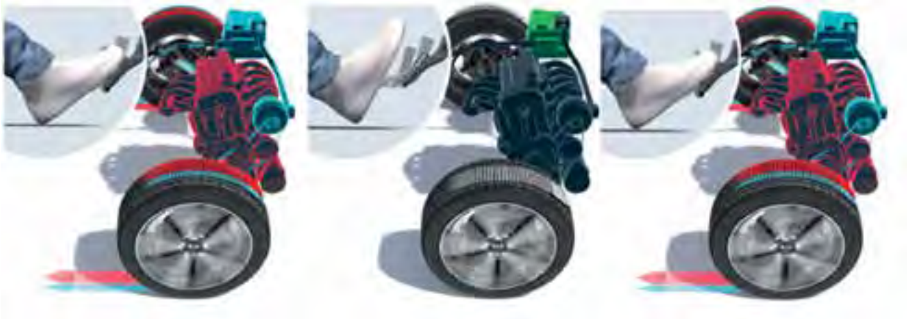
Vereenvoudigde weergave van de Mild Hybrid iMT coasting-functie
